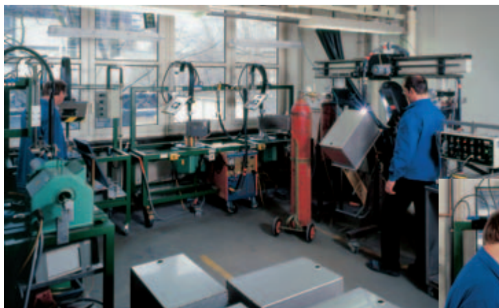
Soudure par des soudeuses TIG en automatique sous gaz inerte pour une haute stabilité des soudures sur les aciers spéciaux.
